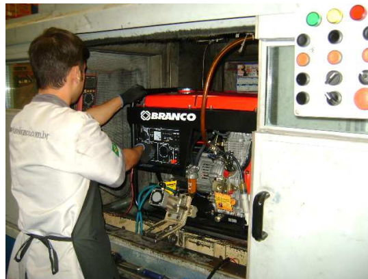
FIGURA 7 - OPERADOR 2 REALIZANDO TESTES NO MOTOGERADOR
