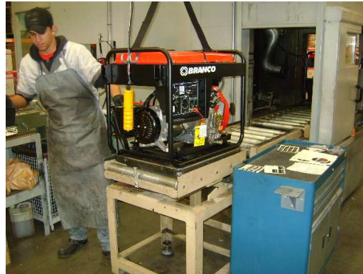
FIGURA 6 - OPERADOR 1 COLOCANDO O MOTOGERADOR NA ESTEIRA
