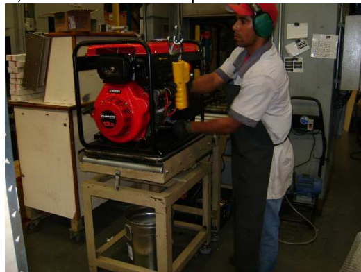
Figura 8 - Operador 3 retirando óleo do motogerador (Foto elaborada pelos autores)
