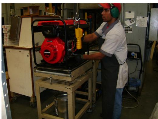
Figura 8 - Operador 3 retirando óleo do motogerador
